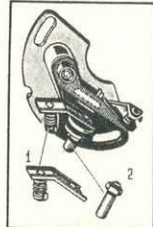
Рис. 2. Полуцикл с контактами прерывателя: 1 — пружинный зажим; 2 — болт.
